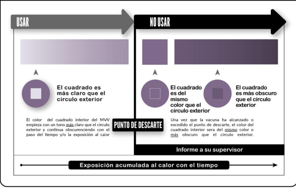
MVV es una etiqueta que contiene un material sensible al calor, que se coloca sobre el vial/ la ampolla de la vacuna para registrar la exposición acumulada al calor con el tiempo. El punto de color aparece en la etiqueta MVV en el recuadro es un punto sensible al tiempo-temperatura que indica el calor acumulado al que el vial ha estado expuesto. Advierte al usuario final cuando es posible que la exposición al calor haya degradado la vacuna más allá de un nivel aceptable.
