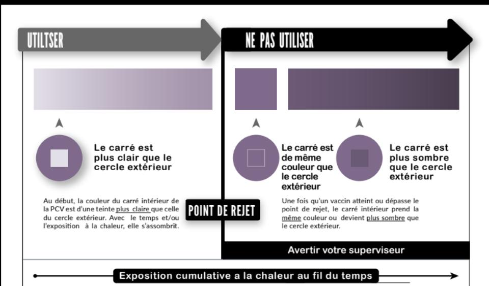
La PCV est une étiquette contenant un matériel thermosensible, apposée sur le flacon/ l'ampoule du vaccin et qui enregistre les expositions thermiques cumulées dans le temps. Le point de couleur en forme de carré sur l'étiquette de la PCV est sensible à la température et au temps et fournit une indication sur l'exposition excessive du flacon à la chaleur. Il avertit l'utilisateur final lorsque l'exposition à la chaleur a éventuellement altéré le vaccin au-delà d'un niveau acceptable.
