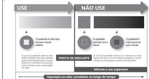
A interpretação do VVM é simples. Concentre-se no quadrado central. Sua cor vai mudar progressivamente. Enquanto a cor do quadrado for mais clara que a cor do círculo, a vacina pode ser usada. Assim que a cor do quadrado central for da mesma cor do círculo ou de uma cor mais escura que o círculo, o frasco deve ser descartado.
