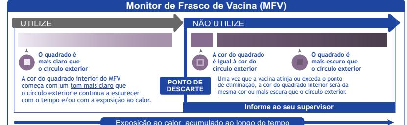
Os Monitores de frascos de vacina (MFV) são sobre a tampa da RABIVAX-S [Vacina Antirábica Inativada (Liofilizada)] fornecida pelo Serum Institute of India Pvt. Ltd. Este ponto é um ponto sensível ao tempo e à temperatura que dá uma indicação do calor cumulativo ao qual o frasco tem sido exposto. Isto avverte o usuário quando a exposição ao calor provavelmente degradou a vacina além de um nível aceitável.
