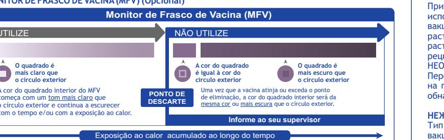
Os monitores de frasco de vacina (MFV) fazem parte da tampa da Vacina Contra Sarampo E Rubéola Viva, Atenuada, fornecida pelo Serum Institute of India Pvt. Ltda. Este ponto é um ponto sensível ao tempo e à temperatura que dá uma indicação do calor cumulativo ao qual o frasco tem sido exposto. Isto adverte o usuário quanto à exposição ao calor provavelmente degradado a vacina além de um nível aceitável.
