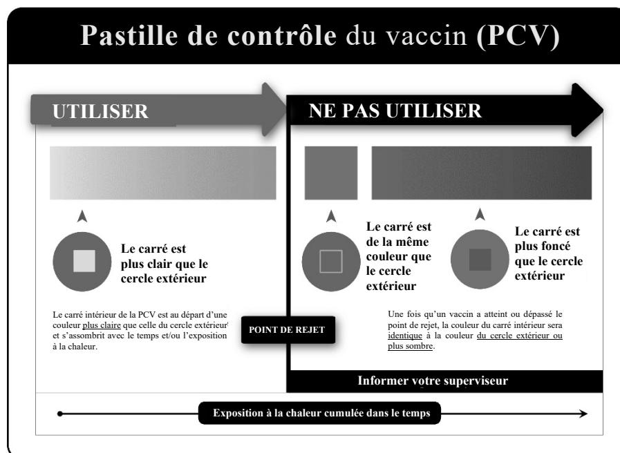
Les pastilles de contrôle du vaccin (PCV) sont incorporées dans l'étiquette du flacon de Gardasil fabriqué par Merck Sharp & Dohme LLC. Le point de couleur qui apparaît sur l'étiquette du flacon est une PCV. Il s'agit d'un point sensible au temps et à la température qui fournit une indication de la chaleur cumulée à laquelle le flacon a été exposé. La pastille avertit l'utilisateur final lorsque l'exposition à la chaleur est susceptible d'avoir dégradé le vaccin au-delà d'un niveau acceptable.
