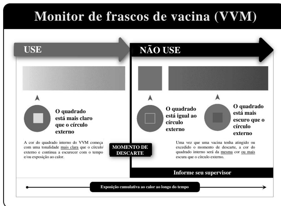
Os Monitores de frascos de vacinas (VVMs) são incorporados ao rótulo do frasco de GARDASIL fabricada pela Merck Sharp & Dohme LLC. O ponto colorido que aparece no rótulo do frasco para injetáveis é um VVM. Este é um ponto sensível ao tempo e à temperatura que fornece uma indicação do calor cumulativo ao qual o frasco foi exposto. Ele alerta o usuário final quando a exposição ao calor provavelmente degradou a vacina além de um nível aceitável.
