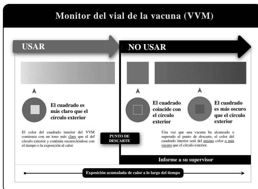
Los monitores de viales de vacunas (VVM) están incorporados en la etiqueta del vial de GARDASIL fabricado por Merck Sharp & Dohme LLC. El punto de color que aparece en la etiqueta del vial es un VVM. Se trata de un punto sensible a la temperatura a lo largo del tiempo que proporciona una indicación del calor acumulado al que se ha expuesto el vial. Advierte al usuario final cuando es probable que la exposición al calor haya degradado la vacuna más allá de un nivel aceptable.
