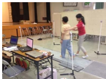
赤外線歩行速度評価システム
